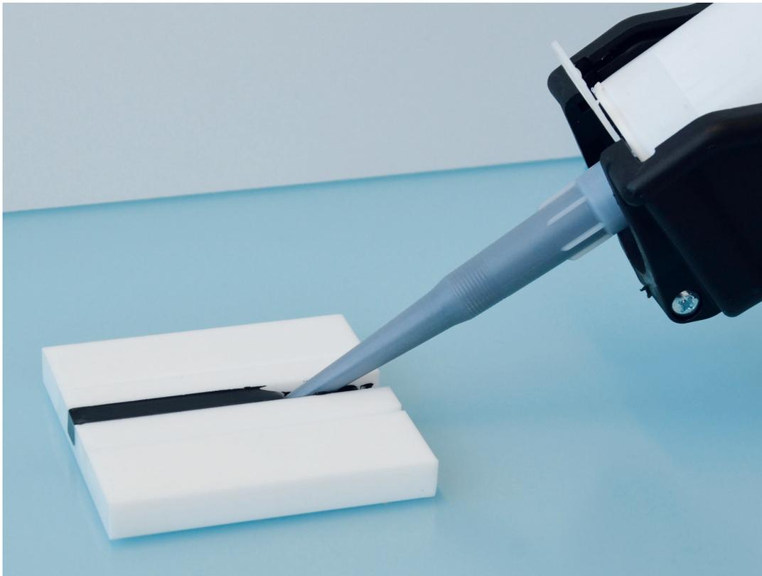
Einbringen der Dichtmasse (schwarz) in einen Prüfkörper aus Polytetrafluorethylen aus der Luftfahrttechnik: Der genaue Aushärtegrad von Dichtmassen lässt sich mit bisher verfügbaren Verfahren nur schwer exakt bestimmen
